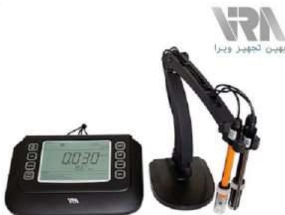
دستگاه مولتی پارامتر رومیزی مدل B2300 برند VIRA مناسب جهت اندازه گیری PH/EC با دقت بالا است که در تحقیقات علمی جهت کنترل کیفیت آب در صنایع بیوتکنولوژی و صنعت شیمی مورد استفاده قرار می گیرد.
